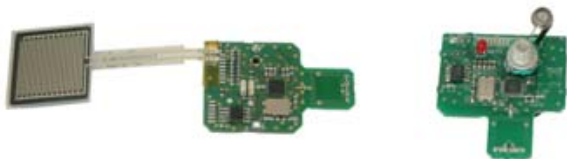
Figure 5 : Dispositifs Physiques du scenario: interrupteur et capteur de luminosité
