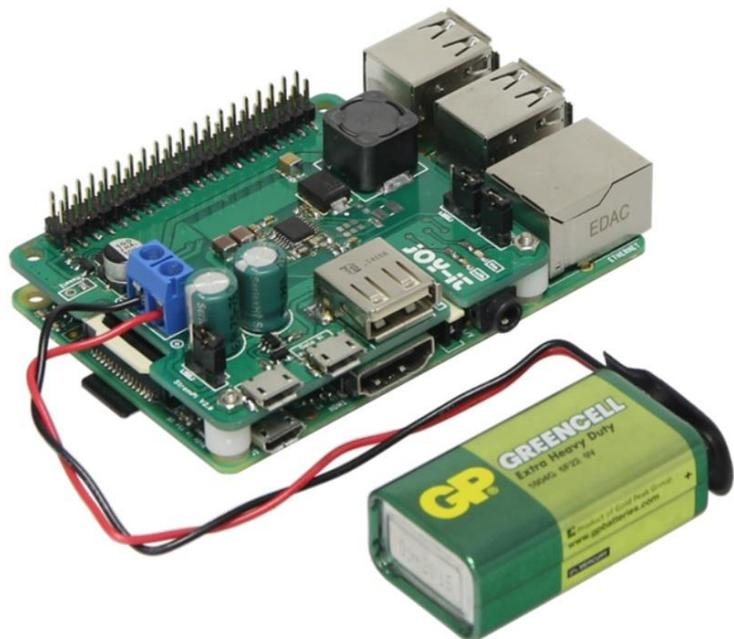
La fonction UPS intégrée permet la sécurisation des applications critiques contre les pannes de courant. Cette fonction peut être surveillée et différents messages peuvent être envoyés par email, en cas de panne par exemple.
